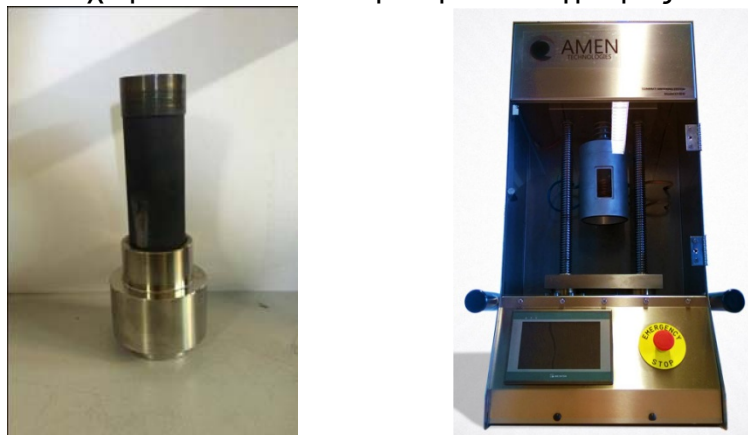
Εικόνα 3.2 Κυλινδρικό δοχείο γραφίτη, AMEN Technologies' Compact Sintering System
