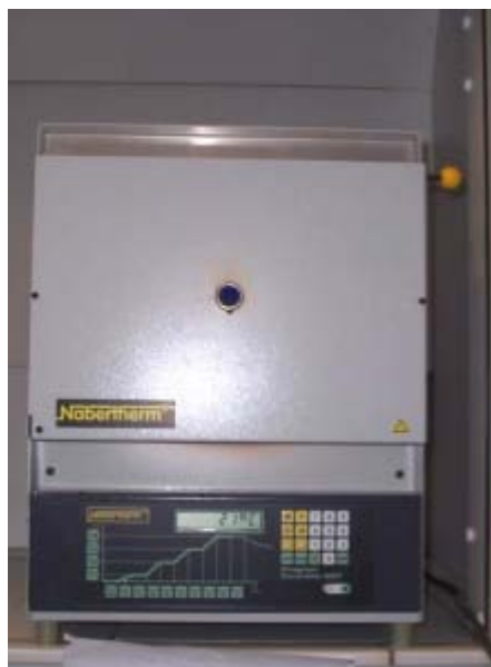
Σχήμα 7.1.2. Ειδικός κλίβανος ανόπτησης
